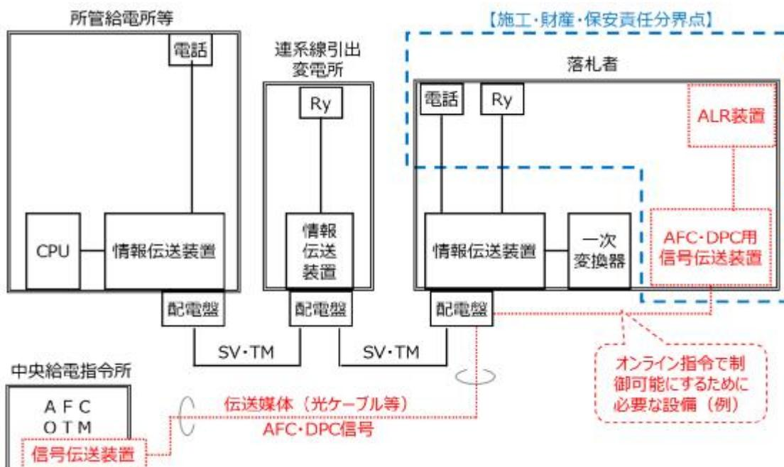
ロ DR を活用した応札者の設備例（専用線オンライン（簡易指令システムを用いたものを除きます。）の場合）
